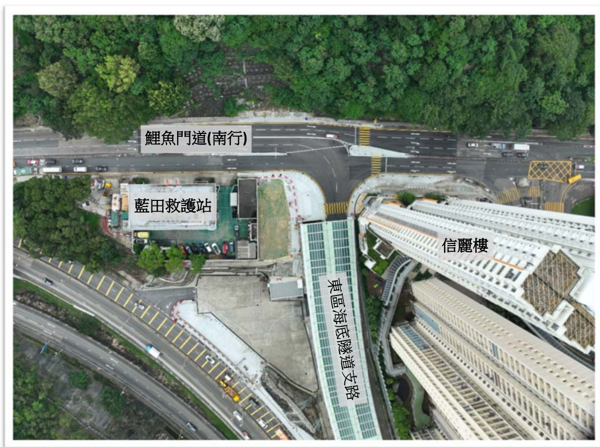
擴闊現有鯉魚門道及重整鯉魚門道與東區海底隧道支路的路口佈局
